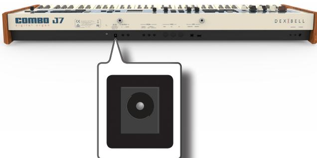
Falls nur ein Kanal für den externen Verstärker benutzt werden soll, L/MONO mit seiner Buchse verbinden. Für optimale Klangqualität sollte in Stereo gearbeitet werden.
