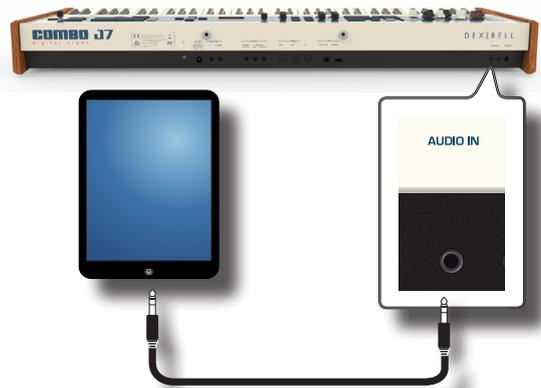
3. Um die Eingangslautstärke der AUDIO IN-Buchse von COMBO J7 einzustellen, die Taste [MENU] drücken und die Funktion AUDIO INPUT wählen.
