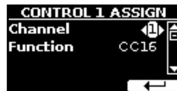
Diese Seiten ermöglichen eine Funktionszuweisung an die Drehknöpfe (1, 2, 3, 4).
