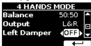
3. Utilizzando i bottoni [▲] [▼] selezionare il parametro "Left Damper" e premere il bottone [▶] per impostare il parametro in "ON".
