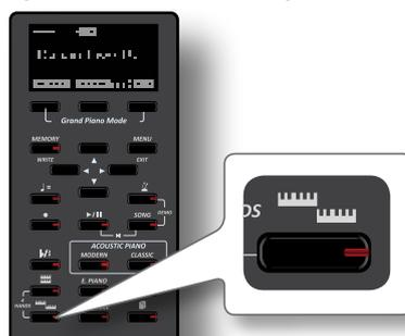
La tastiera si divide in due sezioni. La sezione della tastiera a sinistra del punto di split diventa la parte Lower, mentre la regione della tastiera alla destra del punto di split diventa la parte Main.
