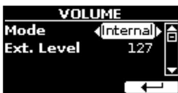
Ora, se si ruota la manopola VOLUME si regola solo il volume degli altoparlanti interni. Il volume delle prese esterne "OUTPUT R - L/MONO" è fissato a 127. Per regolare il volume delle prese "OUTPUT R - L/MONO" occorre modificare il parametro "Ext. Level".
