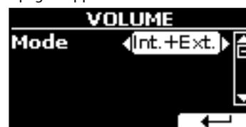
Se si ruota la manopola del volume, si regola il volume degli altoparlanti interni e si regola il suono che esce dalle prese "OUTPUT R - L/MONO". Questo è il comportamento predefinito.
