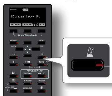
Il bottone [M] lampeggerà, ed il metronomo partirà. Per cambiare il valore del tempo vedere "Come Regolare il Valore del Tempo" (p. 31).
